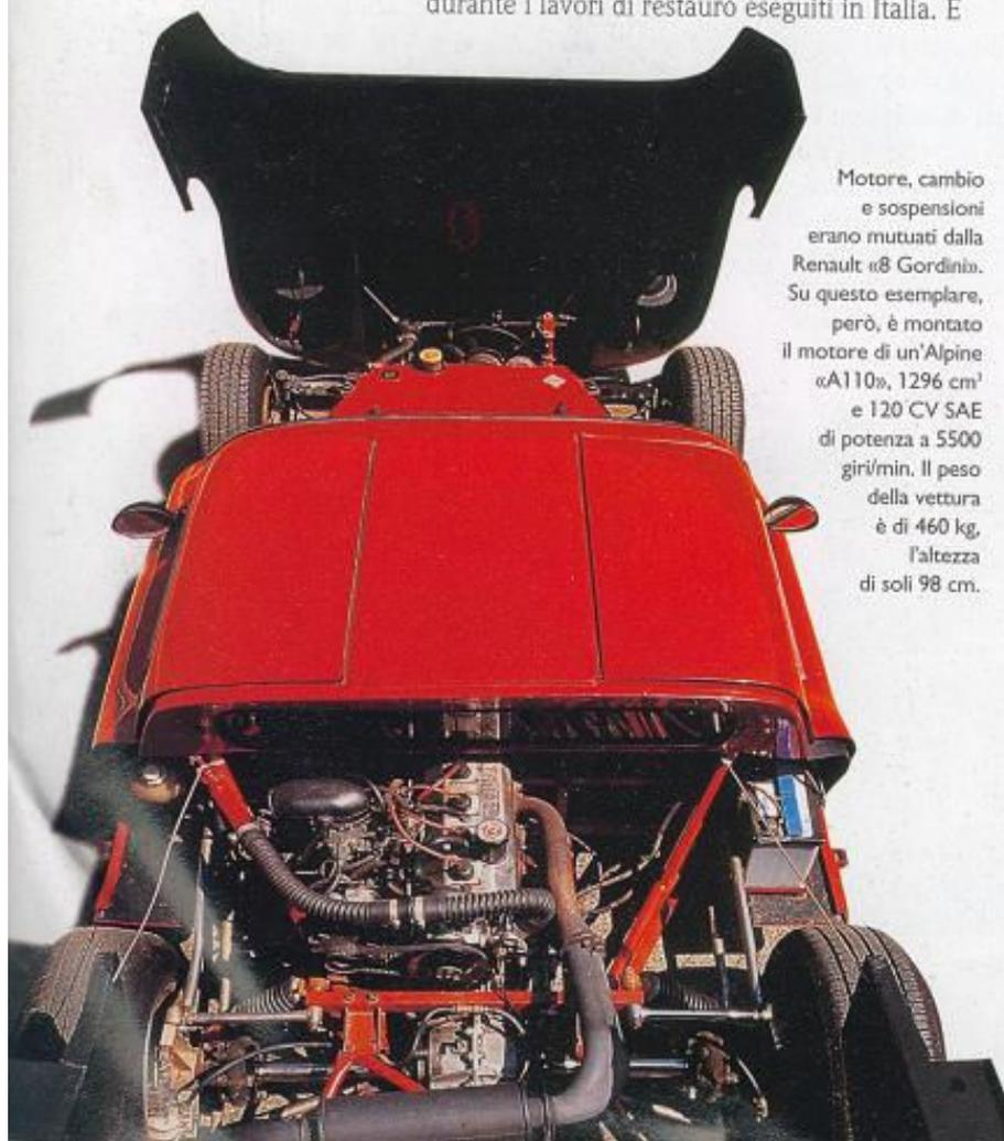
Motore, cambio e sospensioni erano mutuati dalla Renault «8 Gordini». Su questo esemplare, però, è montato il motore di un'Alpine «A110», 1296 cm<sup>3</sup> e 120 CV SAE di potenza a 5500 giri/min. Il peso della vettura è di 460 kg, l'altezza di soli 98 cm.
